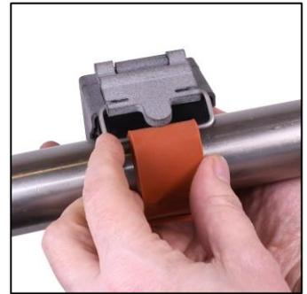
**第 3 步：**拉动凸轮机构，将 HANI™ 夹钳型温度传感器牢牢地拧紧在管道上。
