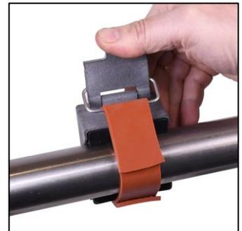
将凸轮机构固定在管道上之后，安装过程便完成了。
