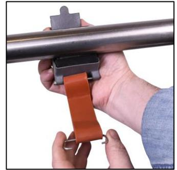
**第 2 步：**将扣环端滑入凸轮杆的侧槽中。
